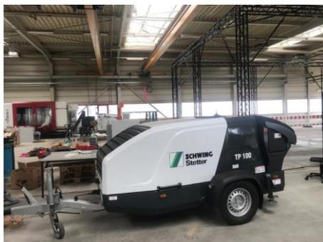
Abbildung 2: Betonpumpe
